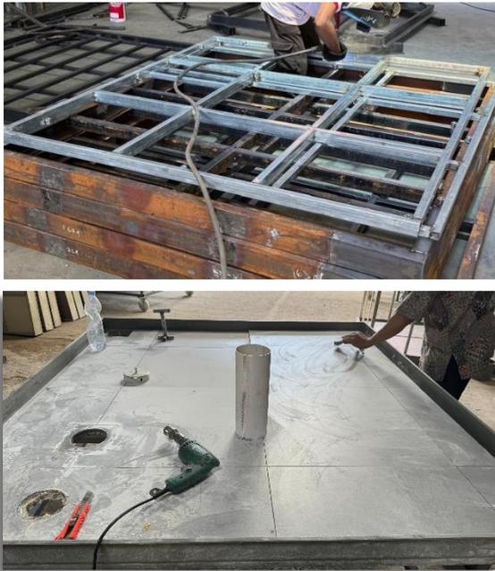
**Gambar 3.** Frame Hollow dan hasil jadi Molding Lantai di Workshop
