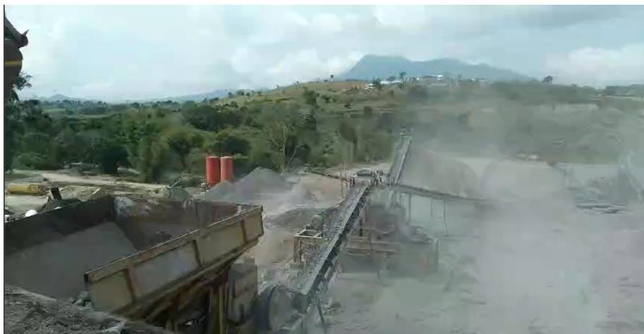
**Gambar 1 – 3 Crusher Produksi Material Batu Belah**
