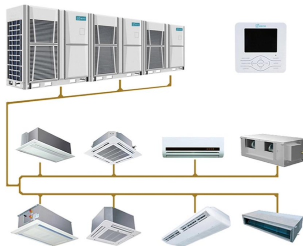
Gambar 2. Sistem AC VRF
