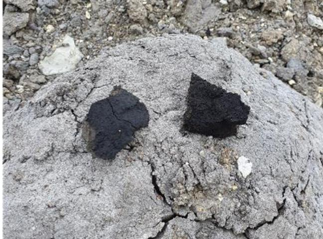
Gambar 2. Spesimen Asbuton di Tambang Lawele, Pulau Buton, Sulawesi Tenggara.
