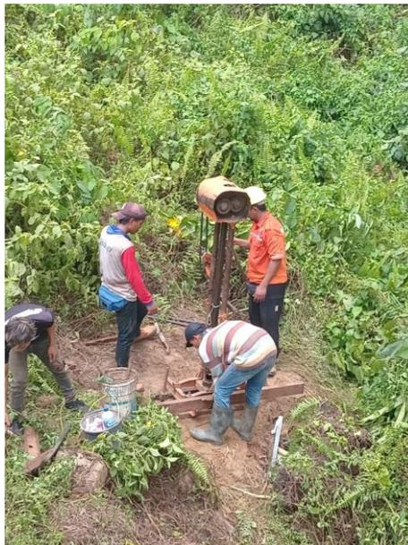
Gambar 5. Pekerjaan sondir
