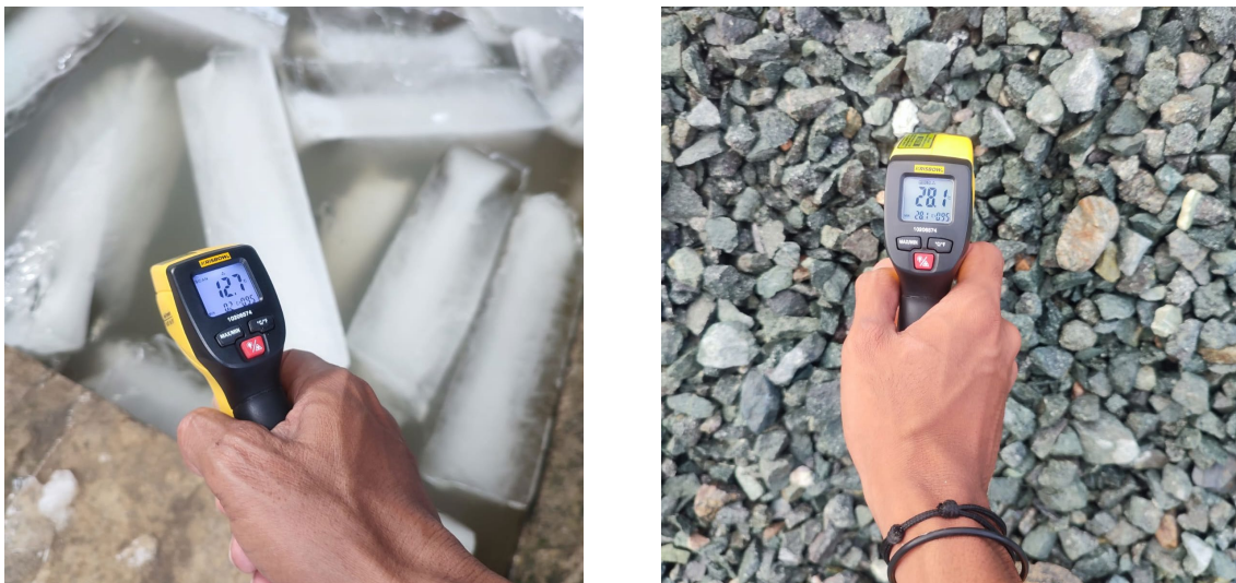
Gambar 5 Pengecekan suhu pada material agregat kasar untuk beton massa
