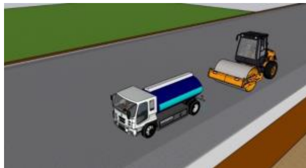
Gambar Pemadatan lapis pondasi agregat kelas A
