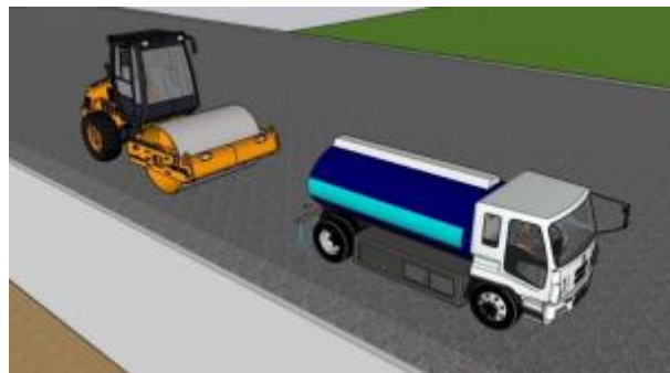
Gambar Pemadatan lapis pondasi agregat kelas B
