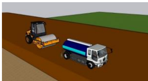
Gambar Pemadatan timbunan pilihan
