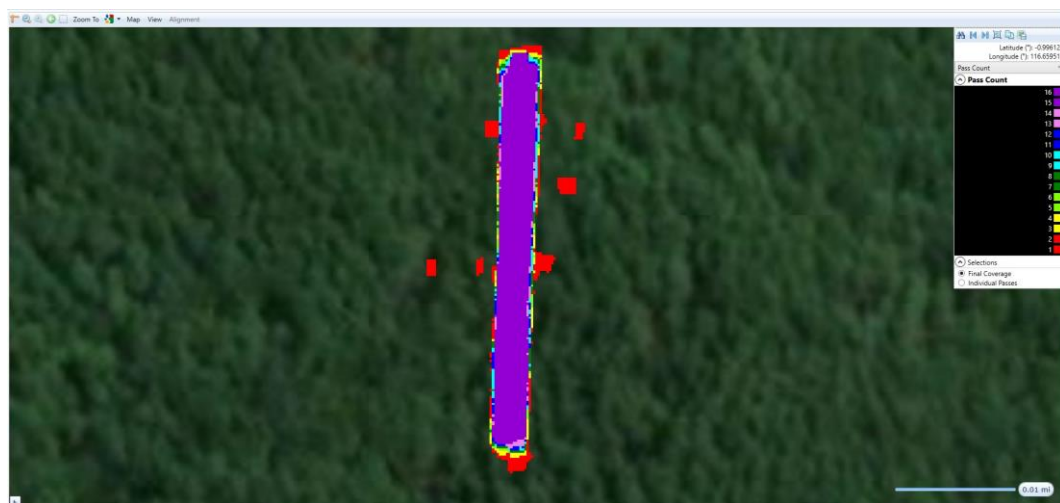
Gambar 20. Tampilan pekerjaan pemadatan pada aplikasi Veta.
