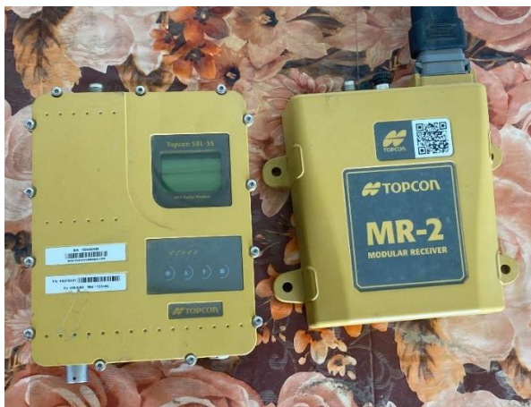
Gambar 8. Base Station, SRL-35 dan MR-2 pada Proyek Pembangunan Jalan Kerja Kawasan Sub BWP 1B dan 1C
